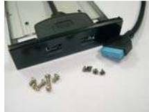
**步驟 2** 用四顆硬碟螺絲，將 2.5" 硬碟 / 固態硬碟鎖至 USB 3.0 前面板上。
